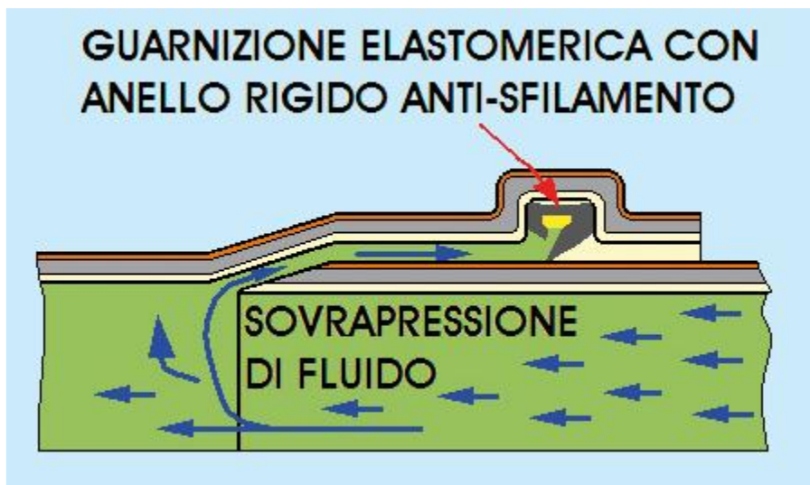
Figura 4. Sistema di giunzione tubo PPHM
