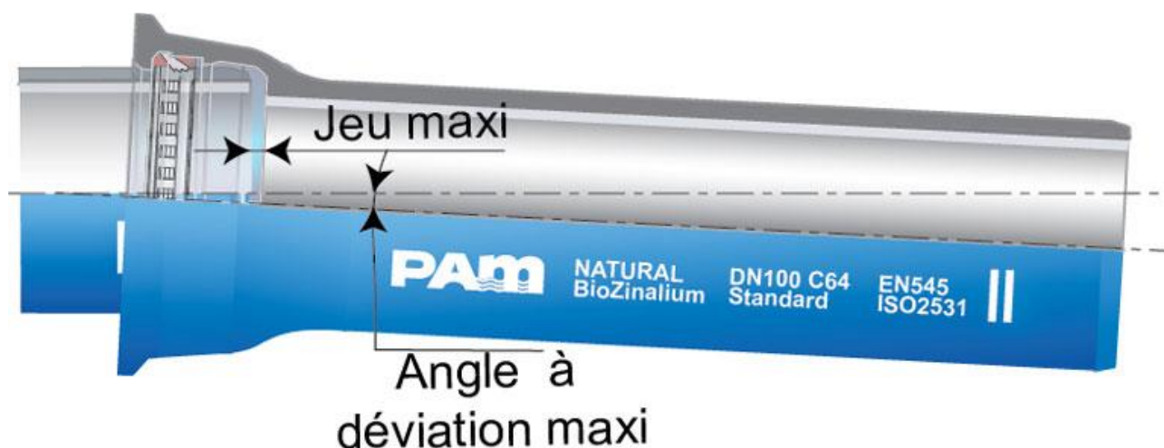
Figura 5 Sistema di giunzione tubo in ghisa
